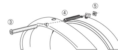
光軸調整ボルトの取付が終わったら、外リムとのマウントの前に、ランプユニットと外リムを概ね平行になるまで光軸調整ボルトを調整してください。
