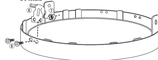
注)：※1詳細図はホンダ車用の取り付け位置です。車両に合わせ下図を参考に光軸ステーを取り付けてください
